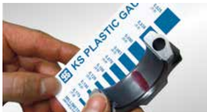
Prüfung des Gleitlagers mit „KS Plastic Gauge“
