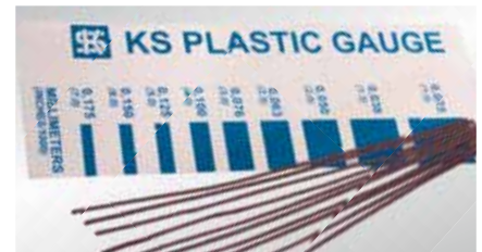
أشرطة القياس "KS Plastic Gauge" للمحامل الانزلاقية (رقم المنتج 50 009 880)
