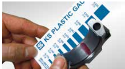
فحص المحامل الانزلاقية بأشرطة "KS Plastic Gauge"
