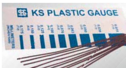
Contrôle du coussinet avec la « jauge KS en plastique »
