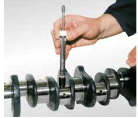
فحص التصلب باستخدام فاحص التصلب الارتدادي (رقم المنتج 50 009 812)
