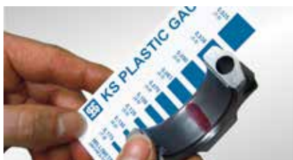
« Jauge KS en plastique » – Bande de calibrage pour coussinets (n° d'article 50 009 880)
