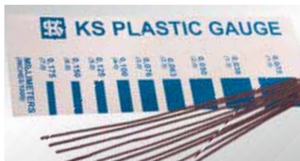
Control del cojinete de deslizamiento con la tira "KS Plastic Gauge"
