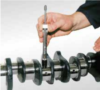
Härteprüfung mit Rückprall-Härteprüfer (Artikel-Nr. 50 009 812)
