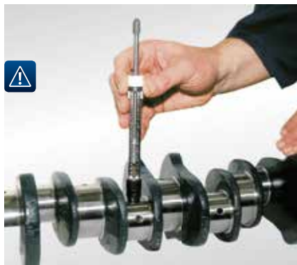
Control de dureza con el escleroscopio (Nº de art. 50 009 812)
