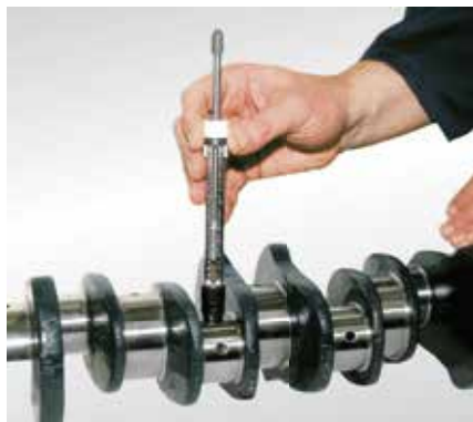
Контроль твердости склероскопом (товарный номер: 50 009 812)
