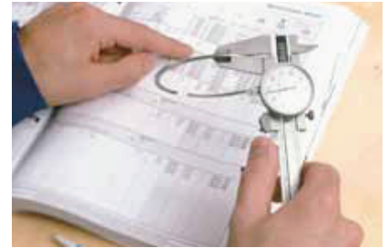
Prüfung mit KS Messschieber mit Rundskala, Genauigkeit 0,01 mm KS Art.-Nr. 50 009 814
