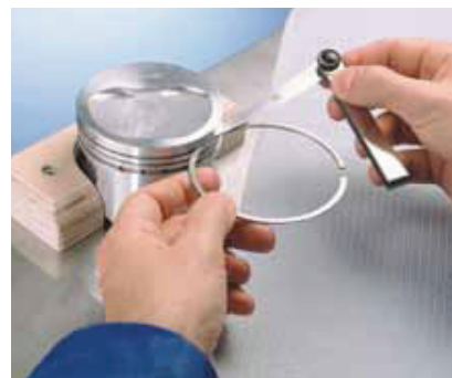
Измерение кольцевых канавок при помощи щупа. Тов. № KS: 50 009 824
