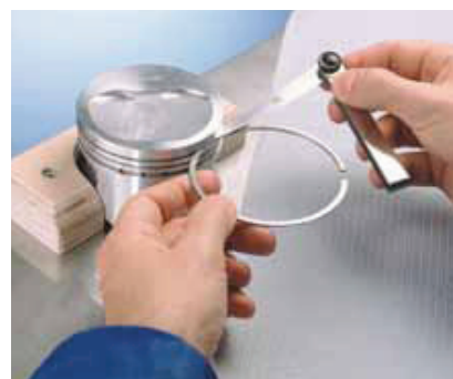
Mesure des gorges de segment de piston avec un calibre d'épaisseur. N° d'article KS 50 009 824
