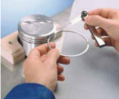
Medición de las ranuras del segmento con calibre de espesores. N.º de artículo KS 50 009 824
