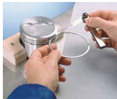
Messung der Kolbenringnuten mit einer Fühlerlehre. KS Art.-Nr. 50 009 824
