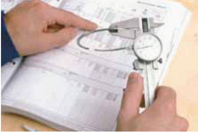
الفحص باستخدام مزلاج القياس KS مع تدريج تقريبي، الدقة تبلغ ٠,٠١ مم رقم جزء KS 50 009 814
