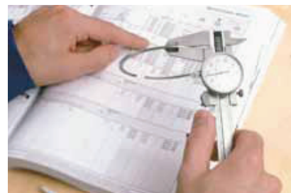
Контроль при помощи штангенциркуля KS с круглой шкалой, точность измерения 0,01 мм Тов. № KS: 50 009 814
