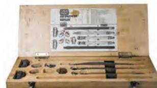
Состав набора: шланги, переходники, хомуты для подключения установки к топливной системе а/м.
