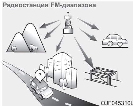
FM сигнал передается на высоких частотах и не искривляется, проходя вдоль поверхности Земли. Поэтому FM сигнал обычно начинает затухать на коротком расстоянии от радиопередающей станции. Кроме того FM сигналы легко нарушаются зданиями, горами и другими препятствиями. Это может привести к определенным состояниям при воспроизведении звука, которые могут выглядеть как неисправность радио. Указанные ниже состояния являются нормальными и не указывают на неисправность радио.
