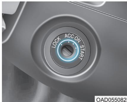
Если передняя дверь открыта, то замок зажигания будет подсвечен при условии, что он не находится в положении ON. Подсветка немедленно выключается при включении замка зажигания или через 30 секунд после закрытия двери. (при наличии)
