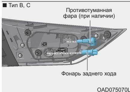
2. Извлеките патрон из блок-фары, повернув его против часовой стрелки до совмещения выступов на патроне с прорезями блок-фары.
