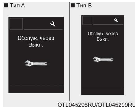
Если интервал технического обслуживания не установлен, на ЖК-экране появится сообщение «Service in OFF» (интервал технического обслуживания выключен).
