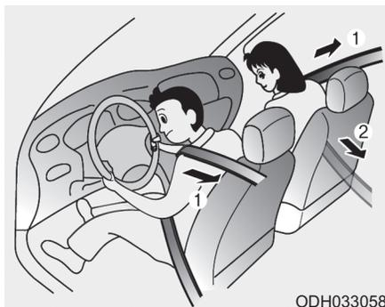
Транспортное средство оборудовано устройствами предварительного натяжения ремней безопасности сидений водителя и переднего пассажира.
