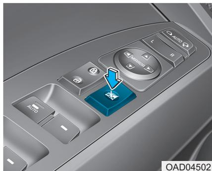
Водитель может заблокировать переключатели стеклоподъемников задних дверей с помощью переключателя блокировки стеклоподъемников.
