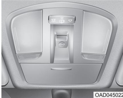
Если транспортное средство оборудовано люком в крыше, его открытие и закрытие производится переключателем на потолочной консоли.
