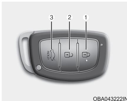
Для автомобилей HYUNDAI используется электронный ключ, которым производится блокирование и разблокирование дверей (и багажника), а также для пуск двигателя.
