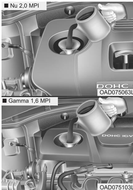
Не заливаете избыточное количество масла. Для предотвращения разлива масла на элементы двигателя используйте воронку.
