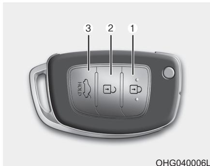
Для автомобилей HYUNDAI используется дистанционный ключ, которым производится блокирование и разблокирование дверей (и багажника), а также пуск двигателя.
