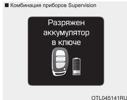
Это предупреждающее сообщение включается, когда при переводе кнопки запуска/останова двигателя в положение OFF (выключено) определяется, что аккумуляторная батарея электронного ключа разряжена.
