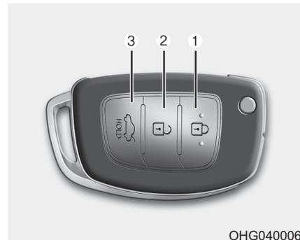
Для блокирования дверей должна быть нажата кнопка блокирования дверей (1) на дистанционном ключе.
