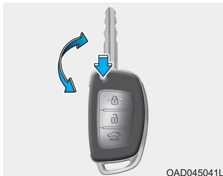
Если дистанционный ключ не функционирует должным образом, замки дверей могут быть заблокированы и разблокированы с помощью механического ключа.
