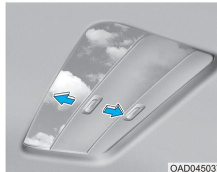
Солнцезащитная шторка при перемещении стеклянной панели открывается автоматически. Если солнцезащитная шторка не закрывается это может быть сделано вручную.
