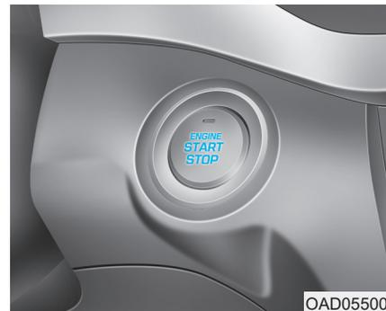
При открытии передней двери загорается кнопка запуска и остановки двигателя. После закрытия двери она горит еще 30 секунд. (при наличии)
