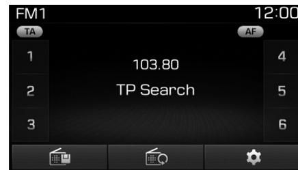
Включение и выключение функции TA (информация о плотности дорожного движения) производится нажатием кнопки **[TA/SCAN] (ДОРОЖНЫЕ СООБЩЕНИЯ/СКАНИРОВАНИЕ)**.
