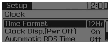
Нажмите кнопку **[SETUP/CLOCK]** (**НАСТРОЙКИ/ЧАСЫ**) ► Выберите **[Clock]** (Часы)
