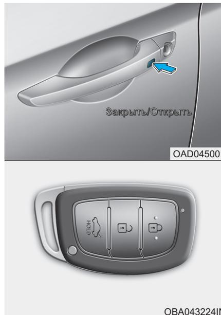
Для блокирования дверей используется кнопка на наружной ручке двери (при этом необходимо иметь при себе электронный ключ) или кнопка блокирования дверей на электронном ключе.
