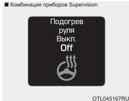
Это предупредительное сообщение отображается при выключении обогрева рулевого колеса.
