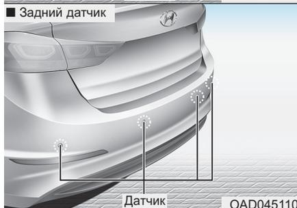
Система помощи при парковке подает звуковые сигналы при обнаружении предметов на расстоянии приблизительно 100 см (40 дюймов) спереди и 120 см (47 дюймов) позади автомобиля.
