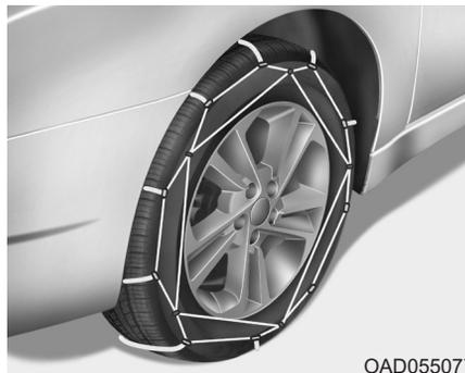
Поскольку боковины радиальных шин тоньше, чем у других типов шин, они могут быть повреждены при установке на них некоторых типов цепей противоскольжения.
