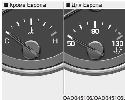
Этот прибор показывает температуру охлаждающей жидкости двигателя, когда кнопка пуска/останова двигателя находится в положении ON (включено).
