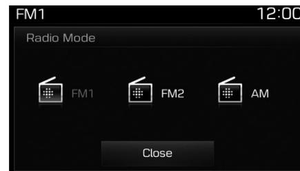
При нажатии кнопки **[RADIO] (РАДИО)** режим работы будет меняться в следующем порядке: FM1 → FM2 → AM.
