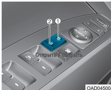
При нажатии на (🔒) часть (1) переключателя производится блокирование всех дверей.
