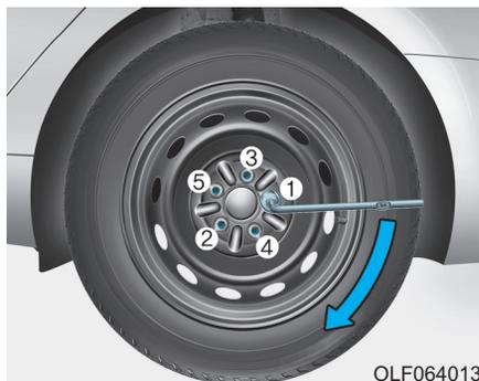
13. С помощью ключа для колесных гаек закрутить гайки крепления колеса в показанной последовательности. Выполнить повторный контроль затяжки каждой гайки. После замены колес рекомендуется как можно скорее обратиться к официальному дилеру HYUNDAI для затяжки колесных гаек с надлежащим моментом затяжки. **Момент затяжки гаек крепления колеса: 11~13 кгс·м (79~94 фунт-сила·фут).**
