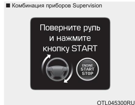
Это предупреждающее сообщение появляется когда рулевое колесо не разблокировано обычным способом при нажатии кнопки пуска/останова двигателя. Кнопку запуска и остановки двигателя следует нажимать, поворачивая рулевое колесо вправо и влево.
