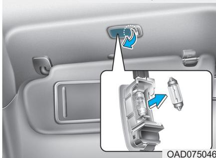
1. С помощью отвертки с плоским жалом аккуратно отделите рассеиватель от корпуса лампы освещения салона.
