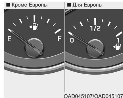
Этим указателем отображается примерное количество топлива в топливном баке.
