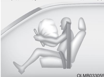
После срабатывания происходит разрыв швов мягкой крышки, которая отделяется под давлением при расширении подушек безопасности. Последующее открытие крышек позволяет полное раскрытие подушек безопасности.
