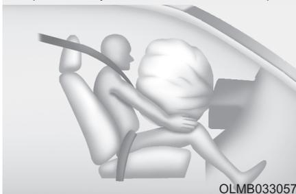
После полного раскрытия подушка сразу же начинает сдуваться, обеспечивая водителю видимость и возможность управления транспортным средством, в случае необходимости.
