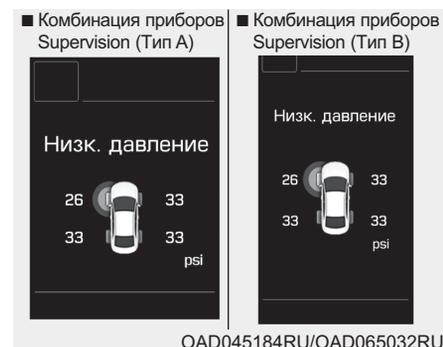
Когда включены предупреждающие индикаторы системы контроля давления в шинах, это означает, что в одной или нескольких шинах давление значительно ниже рекомендованного.
