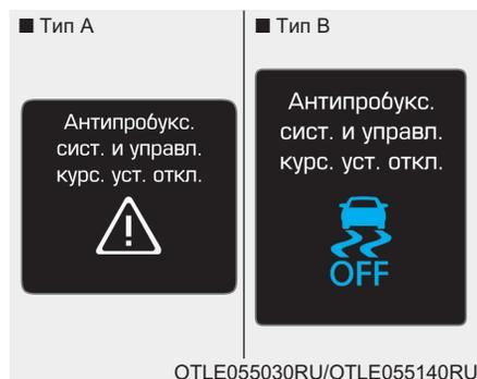
Нажмите и удерживайте кнопку ESC OFF не менее 3 секунд. Высвечиваются сигнализатор ESC OFF и сообщение (на транспортных средствах с комбинацией приборов типа «supervision»), при этом также подается звуковой сигнал. В этом случае отключаются и противобуксовочная функция ESC (управление двигателем), и функция ESC управления тормозами.
