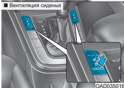
Системы обогрева и вентиляции обеспечивают обогрев и охлаждение передних сидений путем подачи воздуха через небольшие вентиляционные отверстия в поверхности подушек и спинок сидений.
