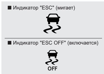
При переводе зажигания в положение ON загорается индикатор ESC. Затем он гаснет, если система ESC работает надлежащим образом.
