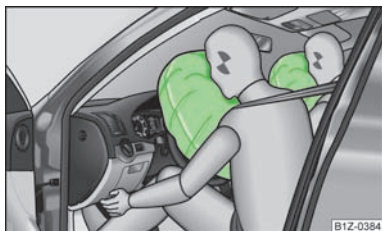
Илл. 118 Газонаполненные подушки безопасности
