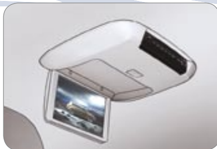
Дисплей встроен в центральную потолочную консоль.
