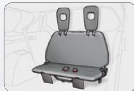
Задний диван можно сложить. Он убирается в нишу под фальш-пол автомобиля.
