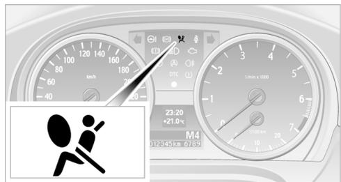
После поворота ключа зажигания в положение „Радио“, см. страницу 47, на несколько секунд загорается сигнальная лампа. Этим она сигнализирует о готовности системы НПБ и преднатяжителей ремней безопасности к работе.
