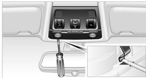
3. Снимите клавишную панель.
