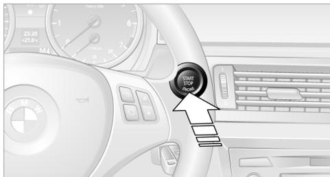
Нажимая на кнопку „Старт/Стоп“, Вы сначала включаете положение „Радио“, потом зажигание, а затем выключаете их.
