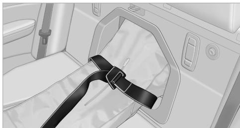
Зафиксируйте содержимое чехла ремнем, затянув его с помощью пряжки.
