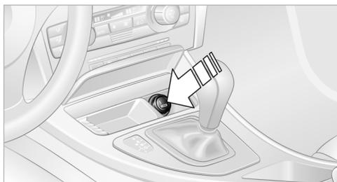
При работающем двигателе или включенном зажигании вдавите прикуриватель в гнездо.
