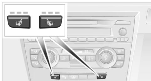
С каждым нажатием клавиши включается следующий температурный режим. При самой высокой температуре горят три светодиода.
