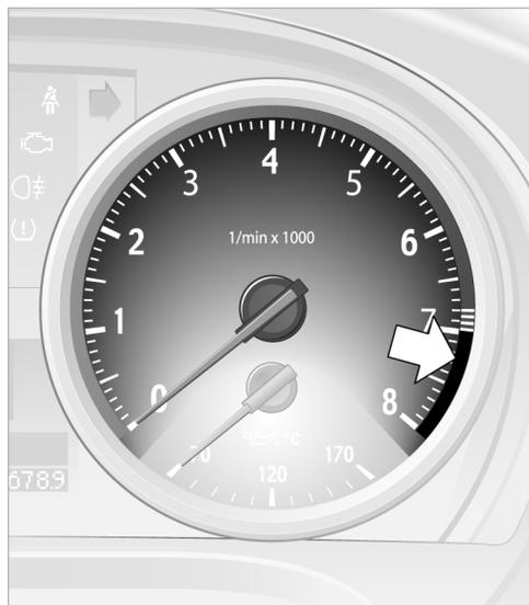
Ни в коем случае не доводите обороты двигателя до значений красного предупреждающего сектора, см. стрелку. В целях защиты двигателя в этом диапазоне прекращается подача топлива.
