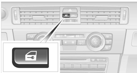
Эта клавиша позволяет при закрытых передних дверях отпереть и запереть двери и крышку багажника. При этом охранная система не включается и лючок топливного бака не запирается\*.
