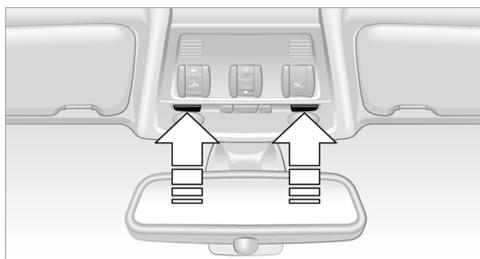
Лампы для чтения находятся рядом с лампами освещения салона спереди и сзади\*. Они включаются и выключаются нажатием клавиши.
