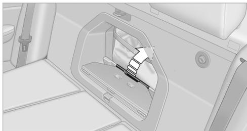
Передняя крышка люка снимается, позволяя использовать всю высоту отверстия. Для этого при опущенной крышке потяните за ручку, см. стрелку, и снимите крышку вперед. Чтобы установить крышку, приложите ее под углом сверху и зафиксируйте.
