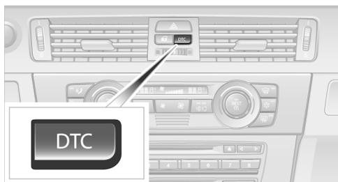
Нажмите указанную клавишу. В комбинации приборов загораются контрольные лампы системы DTC.
