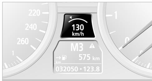
Система запоминает текущую скорость. Значение скорости отображается на спидометре и (кратковременно) на дисплее в комбинации приборов.
