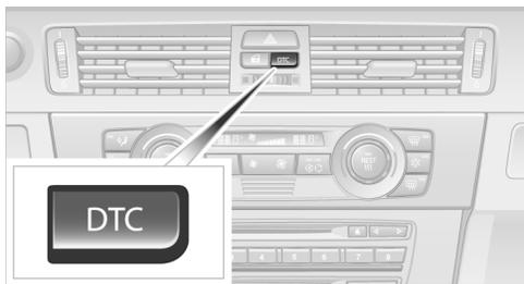
Держите клавишу нажатой не менее 3 секунд. В комбинации приборов загораются контрольные лампы DSC. Одновременно с DSC выключается система динамической регулировки тяги (DTC). Теперь стабилизирующее и повышающее тягу воздействие со стороны систем отсутствует.
