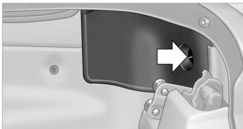
2. Слегка нажав, поверните патрон указателя поворота против часовой стрелки.
