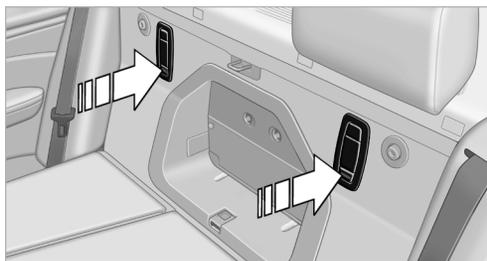
При опущенной спинке задних сидений на перегородке багажника можно найти два крючка для сумок:
