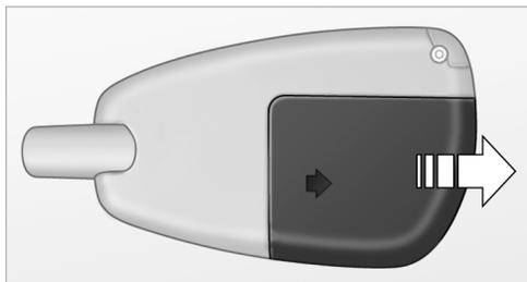
1. Снимите крышку батарейного отсека, см. стрелку.
