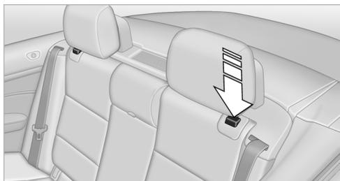
Спинка задних сидений опускается, позволяя перевозить на задних сиденьях груз без риска их повреждения. В зависимости от комплектации с задней стороны спинки могут иметься точки крепления багажной сетки\*. Чтобы отпереть спинку задних сидений, нажмите кнопку на стороне водителя или переднего пассажира.
