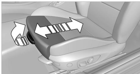
Потяните за рычажок и сдвиньте подколленную опору в удобное положение.
