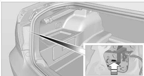
3. Указатель поворота: слегка нажав, поверните лампу против часовой стрелки, выньте и замените ее.
