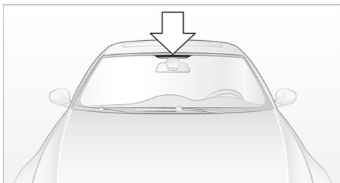
Отмеченный на иллюстрации участок стекла можно использовать для устройств открывания ворот гаража, биллинговых терминалов и других приборов.
