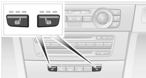
С каждым нажатием клавиши включается следующий температурный режим. При самой высокой температуре горят три светодиода.
