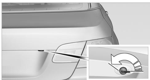
Поверните ключ в замке против часовой стрелки до упора, с переходом за обе точки срабатывания – крышка багажника откроется.
