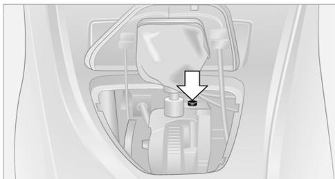
3. Отверткой из комплекта шоферского инструмента, см. страницу 210, прижмите красный рычажок и переведите рычаг селектора в требуемое положение.
