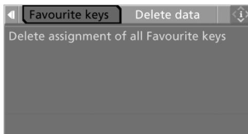
6. Выберите „Delete assignment of all memory keys“ (Удалить назначения всех клавиш) и нажмите на контроллер.
