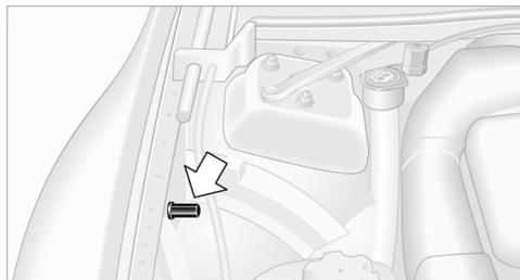
5. Второй зажим кабеля закрепите на минусовой клемме аккумулятора или массе двигателя или кузова у запускаемого автомобиля.
