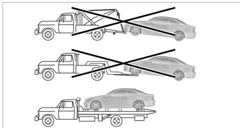
Эвакуацию автомобиля осуществляйте на эвакуаторах с погрузочной платформой.
