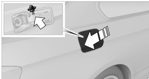
1. Откройте лючок топливного бака. Для этого нажмите на задний край его крышки.
