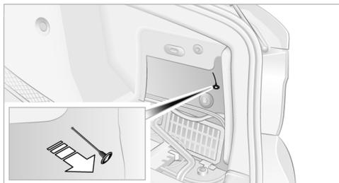
1. Снимите крышку в боковой стенке багажника.
