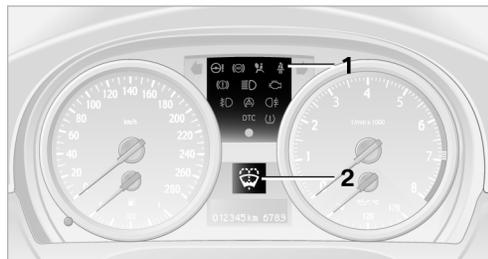
Контрольные и сигнальные лампы загораются разными цветами и в различных комбинациях в секторе 1 и на дисплее 2.
