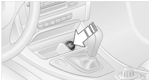
При работающем двигателе или включенном зажигании вдавите прикуриватель в гнездо.
