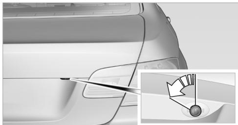
Поверните ключ в замке против часовой стрелки до упора – крышка багажника откроется.
