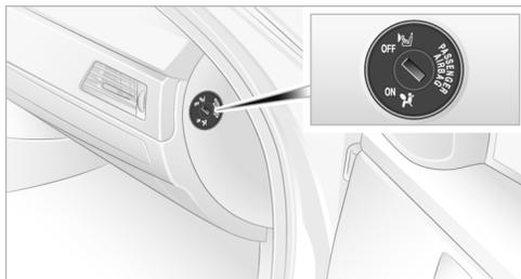
Фронтальную и боковую подушки безопасности переднего пассажира можно отключить и снова включить с помощью специального замка-выключателя. Он находится на торце панели приборов со стороны пассажира.
