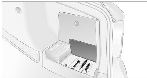
Шоферский инструмент находится в ящике в багажном отделении справа. Чтобы получить доступ к инструменту, снимите крышку.
