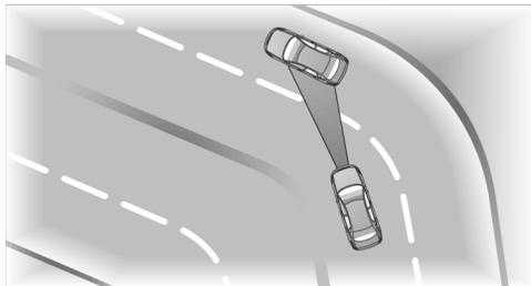
В начале поворота система может временно среагировать на автомобиль, движущийся в соседнем ряду. Притормаживание автомобиля системой можно компенсировать коротким нажатием на педаль акселератора. После отпущания педали акселератора система возвращается в активное состояние и самостоятельно регулирует скорость.
