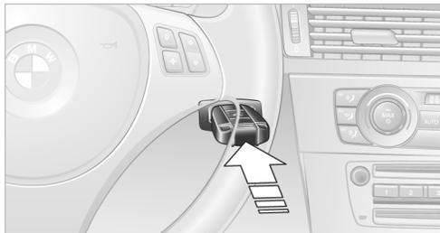
Вставьте электронный ключ до упора в замок зажигания.
