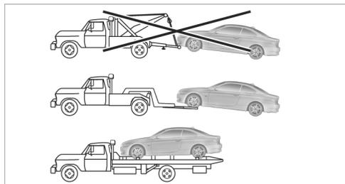
Эвакуацию автомобиля осуществляйте на эвакуаторах с подъемной рамой или погрузочной платформой.
