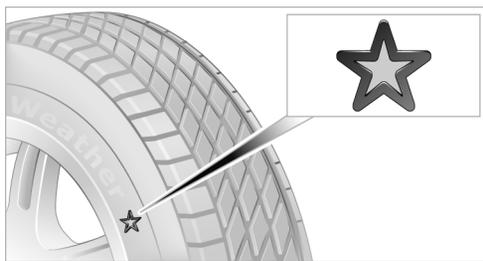
Для каждого типоразмера BMW рекомендует определенные марки шин. Рекомендованные шины можно узнать по отчетливой метке BMW на боковине.
