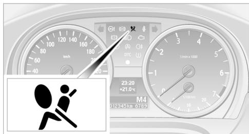
После поворота ключа зажигания в положение „Радио“, см. страницу 58, на несколько секунд загорается сигнальная лампа. Этим она сигнализирует о готовности системы НПБ и преднатяжителей ремней безопасности к работе.
