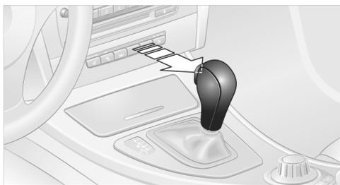
В коробке передач предусмотрена блокировка, которая препятствует случайному включению положений R и P. Чтобы снять блокировку, нажмите кнопку на передней стороне рычага селектора, см. стрелку.
