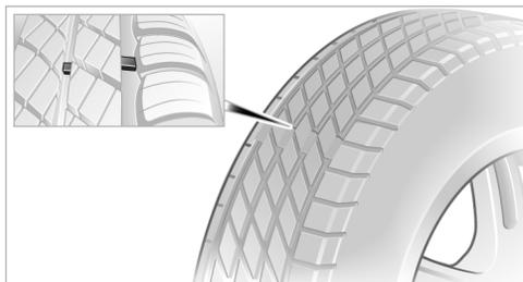
По окружности покрышки распределены индикаторы износа (см. по стрелке) с отмет-
