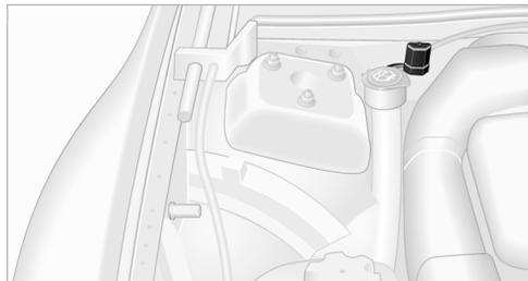
2. Подсоедините один зажим вспомогательного кабеля „+“ к плюсовой клемме аккумулятора или к выводу для подключения внешнего источника питания на помогающем автомобиле.
