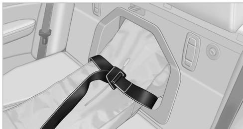
Зафиксируйте содержимое чехла ремнем, затянув его с помощью пряжки.
