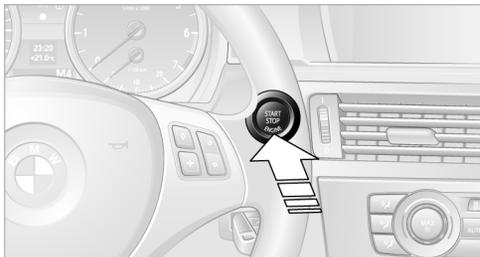
Нажимая на кнопку „Старт/Стоп“, Вы сначала включаете положение „Радио“, затем зажигание, а затем выключаете их.
