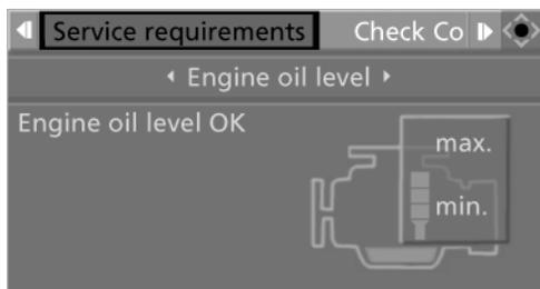
6. Перейдите во второе поле сверху. Поворотом контроллера выберите „Engine oil level“ (Уровень масла) и нажмите на контроллер. На экране отображается уровень масла.
