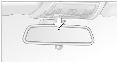
Автоматическим затемнением\* зеркал заднего вида управляют два фотоэлемента, встроенные во внутреннее зеркало. Один фотоэлемент находится в рамке зеркала, см. стрелку, а другой – с тыльной стороны зеркала.
