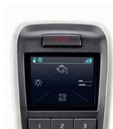
**Контроль над оборудованием.** Запуск и останов двигателя и до четырех КОМ. Можно также регулировать частоту вращения двигателя и сохранять значения ЧВД для быстрого вызова в дальнейшем.
