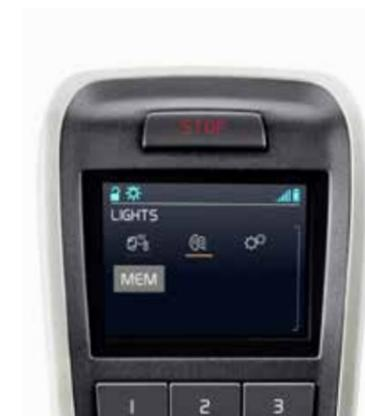
**Включение освещения.** Оснащен ли ваш грузовой автомобиль рабочими прожекторами, проблесковыми маячками или световыми спецсигналами от изготовителя кузовов? Функция дистанционного управления позволяет включать и выключать их.
