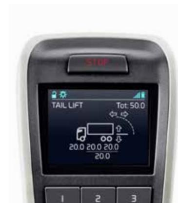
**Встроенные органы управления задним подъемным бортом.** Не нужно носить с собой два пульта ДУ. Пульт дистанционного управления позволяет удобно поднимать и опускать задний подъемный борт.
