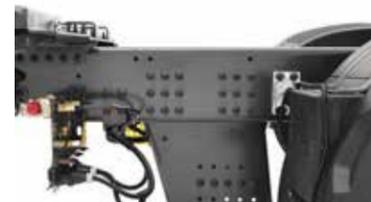
**Ряд отверстий для особых целей.** Рама располагает верхним рядом отверстий, которые предназначены для крепления надстройки. В этом ряду заклепки не используются, поэтому изготовитель кузова может свободно установить оборудование.
