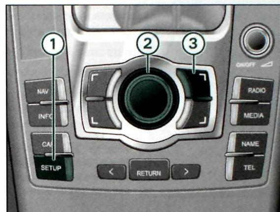
Илл. 12 Терминал MMI: комбинация клавиш при перезагрузке системы
