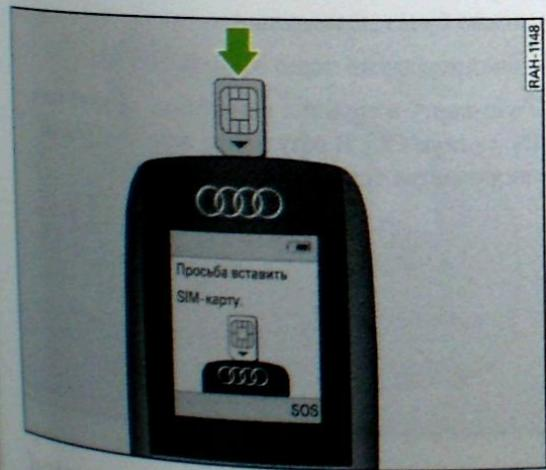
Илл. 161 Трубка с клавишами: положение SIM-карты при установке
