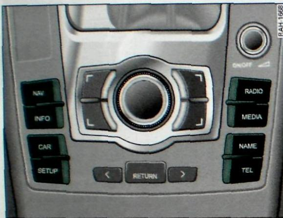
Илл. 4 Терминал MMI: функциональные клавиши
