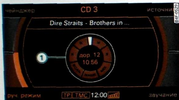
Илл. 28 Дисплей MMI: колесо управления (на примере режима CD)
