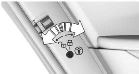
Разблокируйте или заблокируйте защитные выключатели на задних дверях с помощью интегрированного ключа.
