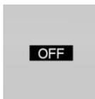
В комбинации приборов отображается OFF. Привод выключен, и Готовность к работе включена.
