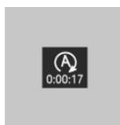
Режим движения ECO PRO: в зависимости от комплектации, во время автоматической остановки двигателя отображается общее время, в течение которого двигатель был остановлен с помощью функции автоматического запуска/остановки двигателя.
