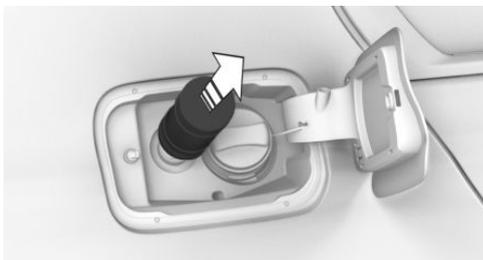
7. Установите крышку бака и поверните ее по часовой стрелке.
