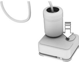
Дайте компрессору поработать в течение макс. 10 минут, чтобы ввести герметик и создать давление в шинах приблизительно 2,0 бар.
