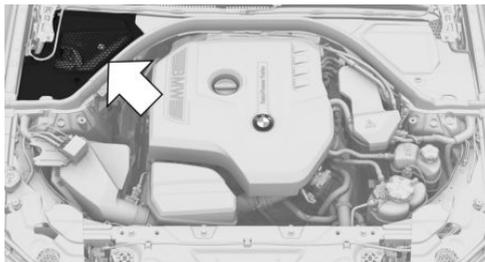
В моторном отсеке под кожухом на стороне переднего пассажира расположена аккумуляторная батарея для технологии Mild Hybrid.
