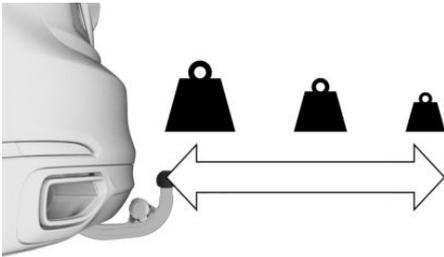
Допустимая полная масса нагруженного заднего навесного багажника зависит от того, насколько далеко его центр тяжести удален от шаровой головки.
