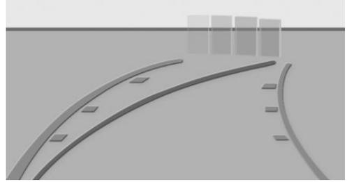
Препятствия сзади автомобиля распознаются датчиками системы сигнализации аварийного сближения при парковке PDC.
