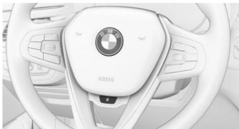
Кнопка обогрева рулевого колеса
