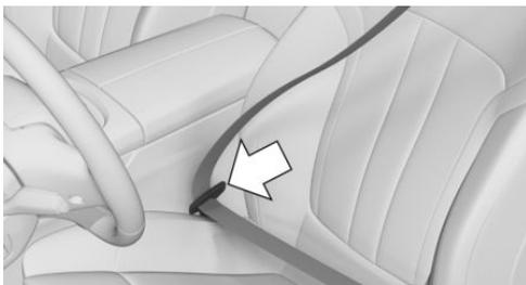
При пристегнутом ремне безопасности во время трогания лента ремня безопасности водителя и пассажира переднего сиденья однократно натягивается в автоматическом режиме.
