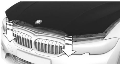
Захлопните крышку капота с высоты примерно 50 см.
