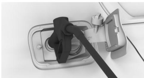
5. Установите крышку бака и поверните ее по часовой стрелке.
