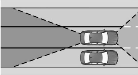
Радиолокационные датчики, начиная с минимальной скорости и до прибл. 210 км/ч, контролируют пространство рядом с автомобилем.
