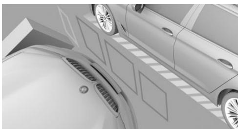
Для защиты боковых сторон кузова выделенные препятствия отображаются сбоку автомобиля.
