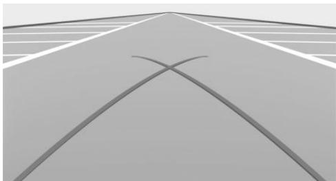
Траектории движения колес при повороте могут выводиться на изображение с видеокамеры только вместе с траекториями движения колес по прямой.
