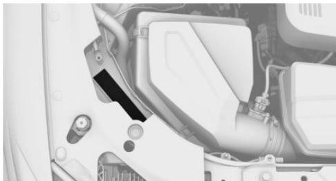
Нанесенный VIN указан в моторном отсеке с правой стороны автомобиля.
