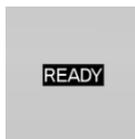
Индикатор в комбинации приборов сигнализирует, что функция системы автоматического запуска/останова двигателя готова к автоматическому запуску двигателя.
