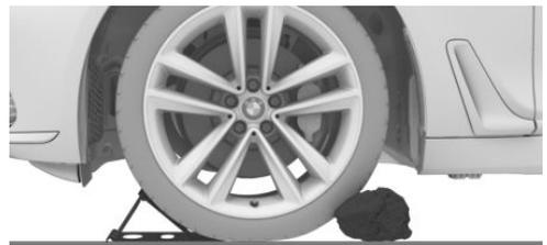
Подложите противооткатные упоры или другие подходящие предметы перед и за колесом, расположенным по диагонали напротив заменяемого колеса.
