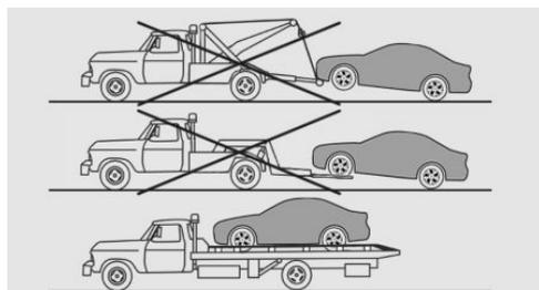
Транспортируйте автомобиль только на погрузочной площадке.
