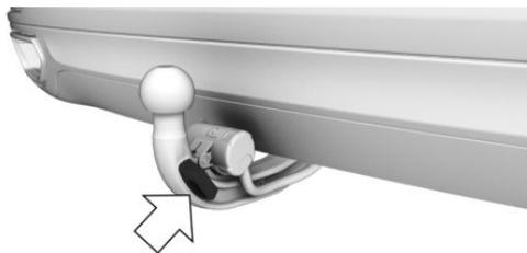
Для крепления предохранительного троса прицепа на тягово-сцепном устройстве предусмотрена специальная проушина.
