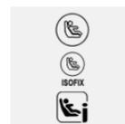
Соответствующим символом отмечены места установки нижних креплений ISOFIX.
