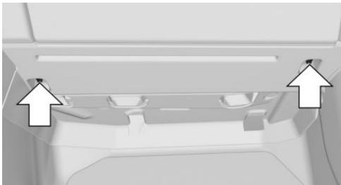
Отсоединить крепления, стрелки, и снять кожух.
