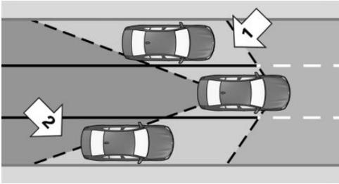
Радиолокационные датчики, начиная с минимальной скорости, контролируют пространство сзади автомобиля и рядом с ним.
