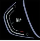
Стрелка рядом с символом бензоколонки показывает, на какой стороне автомобиля находится лючок топливного бака.
