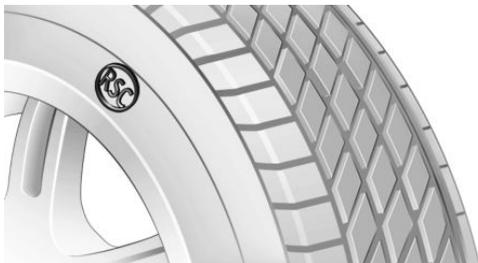
Шины снабжены маркировкой RSC–Runflat System Component (системный компонент RSC Runflat: шины, допускающие движение в аварийном режиме) на боковой стенке.
