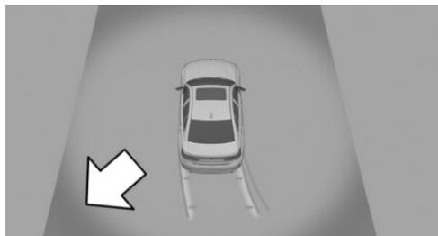
Соответствующая крайняя область в окне системы сигнализации аварийного сближения при парковке PDC мигает красным цветом, когда датчики распознают автомобили.
