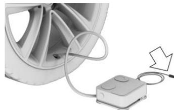
5. Включите компрессор при включенной готовности к работе или к движению.
