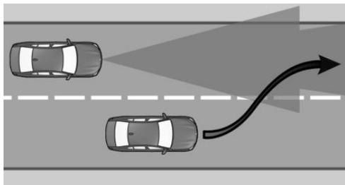
При внезапном вклинивании движущегося впереди транспортного средства в вашу полосу движения система может оказаться неспособной самостоятельно восстановить заданную дистанцию. При высокой разности скоростей невозможно восстановить выбранное расстояние до движущегося впереди автомобиля, например, при быстром приближении к грузовому автомобилю. Если система уверенно распознает движущееся впереди транспортное средство, она призывает водителя затормозить или выполнить обгонной маневр.
