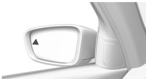
Лампа в наружном зеркале заднего вида мигает, когда задние датчики распознают автомобили и собственный автомобиль движется назад.
