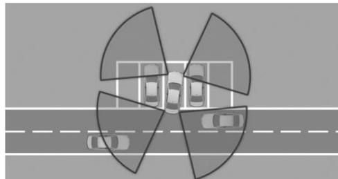
Два радиолокационных датчика в заднем бампере контролируют пространство за автомобилем.
