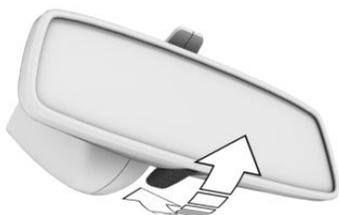
Для уменьшения слепящего действия внутренним зеркалом заднего вида поверните рычаг вперед.
