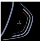
▶ Холодный двигатель: светодиоды индикатора сигнализируют о низком значении температуры. Выполняйте движение при умеренном
