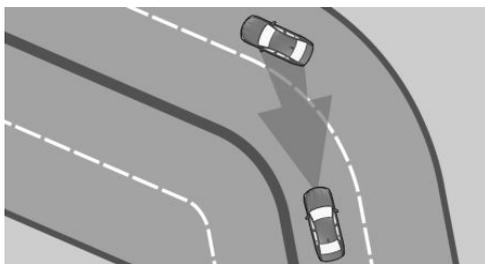
В начале поворота система может кратковременно среагировать на автомобиль, движущийся в соседнем ряду. Притормаживание автомобиля системой можно компенсировать коротким ускорением. После отпущения педали газа система возвращается в активное состояние и самостоятельно регулирует скорость.
