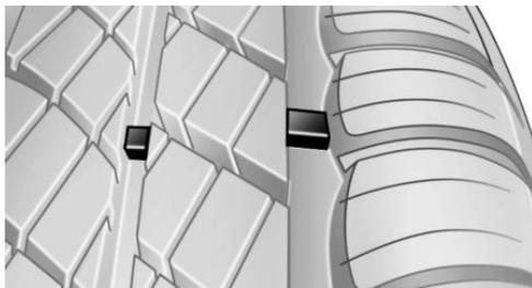
По периметру шин распределены индикаторы износа. Эти индикаторы износа в соответствии с предписаниями закона имеют минимальную высоту 1,6 мм.
