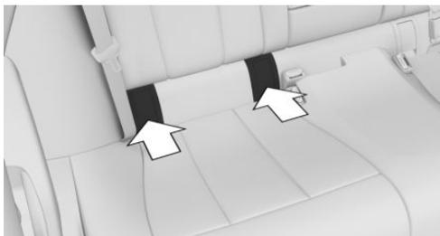
Крепления для нижних фиксаторов ISOFIX находятся за обозначенными накладками.
