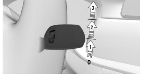
Отожмите рычаг вверх, пока не будет достигнуто нужное положение.
