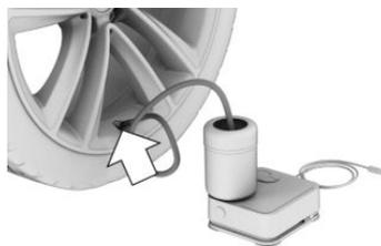
5. Вставьте разъем в розетку в салоне автомобиля при выключенном компрессоре.
