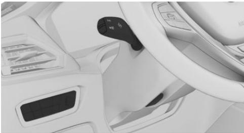
Элемент переключателя света находится рядом с рулевым колесом.
