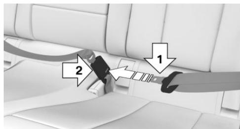
4. Протяните ремень безопасности до крепления на полке за задним сиденьем.
