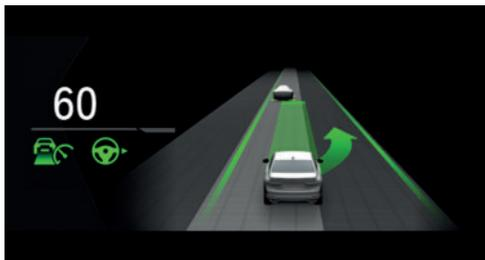
Пример: контрольные и предупредительные лампы для активного круиз-контроля с функцией Stop&Go ACC и ассистент смены полосы движения сигнализируют о смене полосы на соседнюю. Одновременно, смена полосы движения на соседнюю отображается в анимированной форме в Assisted Driving View.
