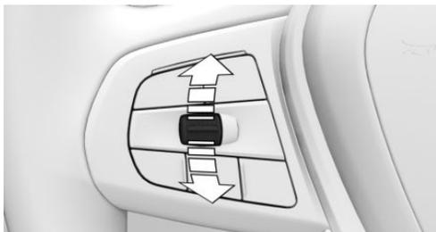
Нажмите на двухпозиционный переключатель в прерванном состоянии один раз вверх или вниз.
