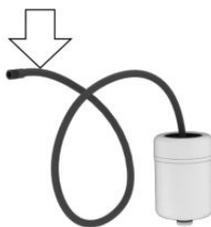
3. Вставьте емкость с уплотняющим средством в крепление на корпусе компрессора до фиксации со слышимым щелчком.
