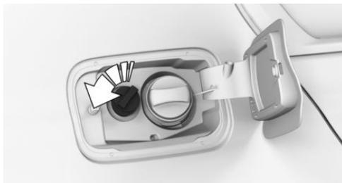
3. Вставьте пробку топливного бака в скобу на крышке лючка.
