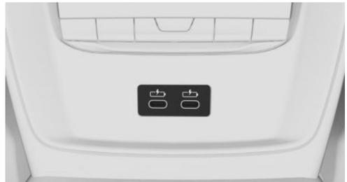
В центральной консоли задней части салона расположены два разъема USB.
