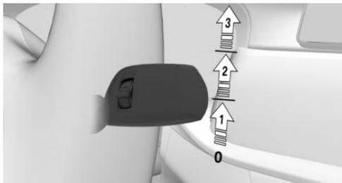
Отожмите рычаг вверх, пока не будет достигнуто нужное положение.
