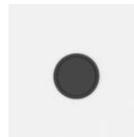
Ультразвуковые датчики сигнализации аварийного сближения при парковке (PDC) находятся в бамперах.
