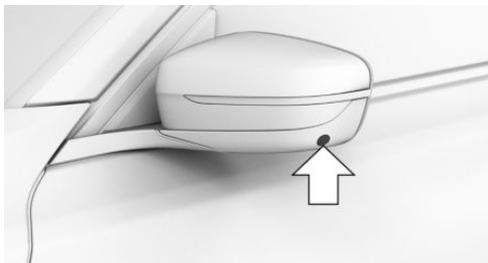
В нижней части корпусов наружных зеркал имеется по одной видеокамере.
