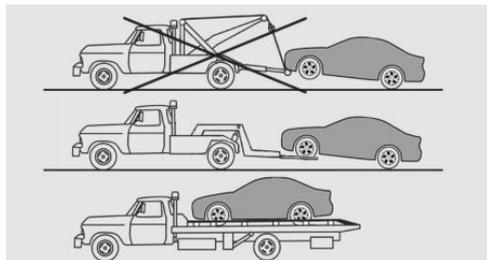
Транспортируйте свой автомобиль тягачом с подъемной стойкой или на погрузочной площадке.
