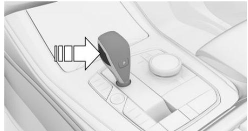
3. Переместите рычаг селектора в нужном направлении, при необходимости с переходом за точку срабатывания. После отпущения рычаг селектора возвращается в нейтральное положение.
