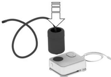
4. Прикрутите наполнительный шланг емкости уплотнительного средства к вентилю шины неисправного колеса.
