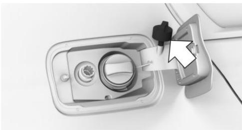
4. Установите емкость и проверните ее до упора по часовой стрелке.
