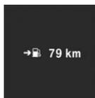
Текущий запас хода в виде числового значения отображается между спидометром и тахометром.
