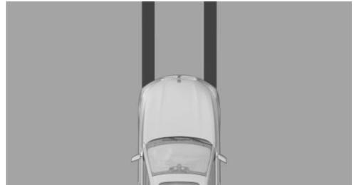
Вид моечной установки помогает при въезде в моечную установку за счет отображения собственной полосы движения.
