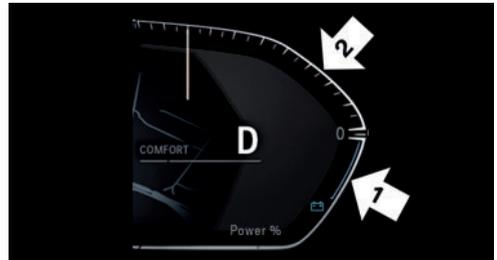
Указательная стрелка в зоне стрелки 1: индикация рекуперации движения в результате движения по инерции или замедления, CHARGE.
