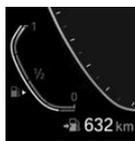
Стрелка рядом с символом бензоколонки показывает, на какой стороне автомобиля находится лючок топливного бака.
