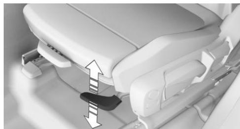
Нажимайте на рычаг вниз или тяните вверх до тех пор, пока не установится желаемый угол наклона сиденья.
