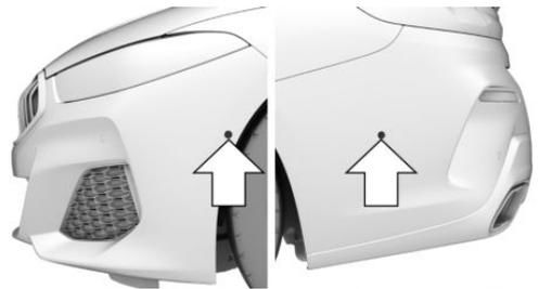
Ультразвуковые датчики парковочного ассистента находятся сбоку на автомобиле.
