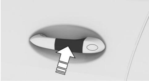
Держите антенну беспроводной связи ближнего радиуса действия в смартфоне прямо и по центру наружной ручки двери водителя.
