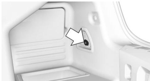
Кнопка для выдвигания и задвигания шаровой головки находится в багажном отделении.
