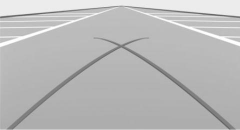
Траектории движения колес при повороте могут выводиться на изображение с видеокamеры только вместе с траекториями движения колес по прямой.
