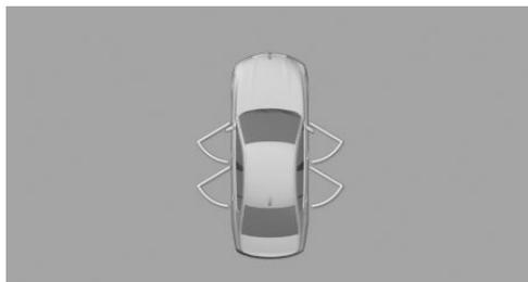
Ручная коробка передач: во время стоянки автомобиля через непродолжительное время отображаются максимальные углы открытия дверей.
