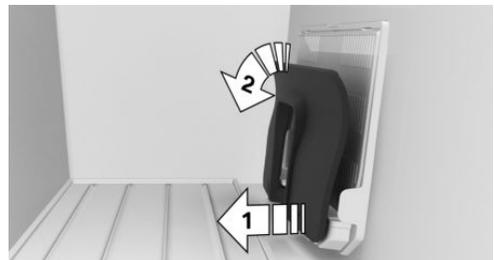
3. Вставьте мобильный телефон дисплеем на стороне фиксатора в лоток.
