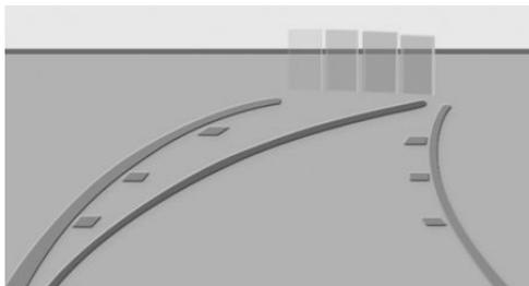
В зависимости от комплектации препятствия сзади автомобиля распознаются датчиками системы сигнализации аварийного сближения при парковке PDC.
