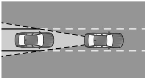
Радиолокационные датчики контролируют пространство сзади автомобиля.
