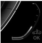
▶ Холодный двигатель: стрелка находится на низком значении температуры. Выполняйте движение при умеренном числе оборотов и с умеренной скоростью.
