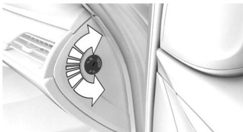
Замок-выключатель НПБ переднего пассажира находится с наружной стороны панели приборов.
