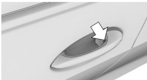
Троньте пальцем и удерживайте на протяжении примерно 1 секунды рифленую поверхность кнопки на ручке закрытой двери водителя, не берясь за ручку.
