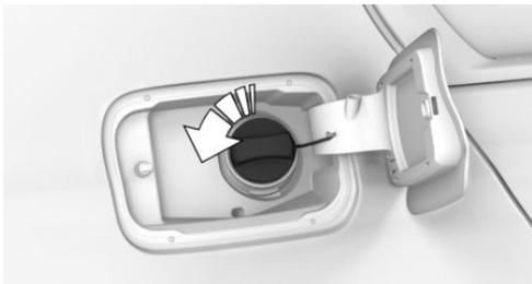
3. Вставьте пробку топливного бака в скобу на крышке лючка.
